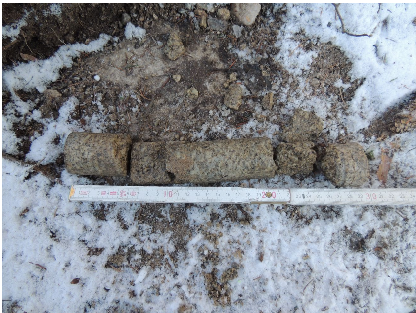
Vývrt ze sondy B – pravá opěra na odtokové straně
