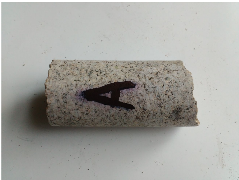
Vzorek ze sondy A – levá opěra na nátokové straně
