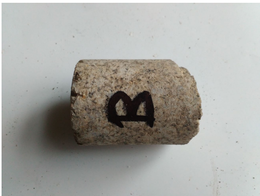
Vzorek ze sondy B – pravá opěra na odtokové straně
