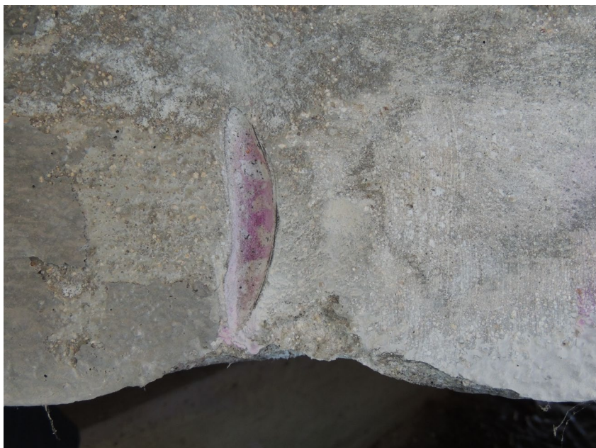
Měření hloubky karbonatace betonu desky
