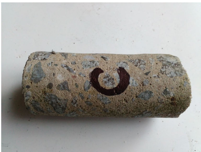
Vzorek ze sondy C – deska mostu - poblíž nátokové strany, přibližně uprostřed rozpětí
